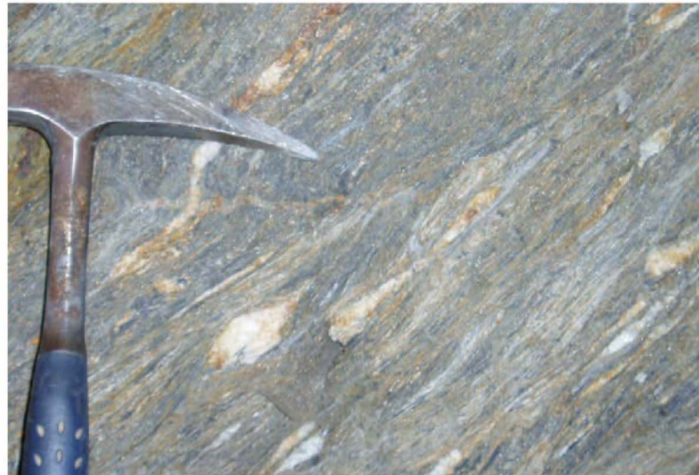
図8. 泥岩・砂岩互層起源のフィローナイト. 白色部は石英集合体(Q)あるいは石英・長石集合体(C)(ジオサイト2A)
